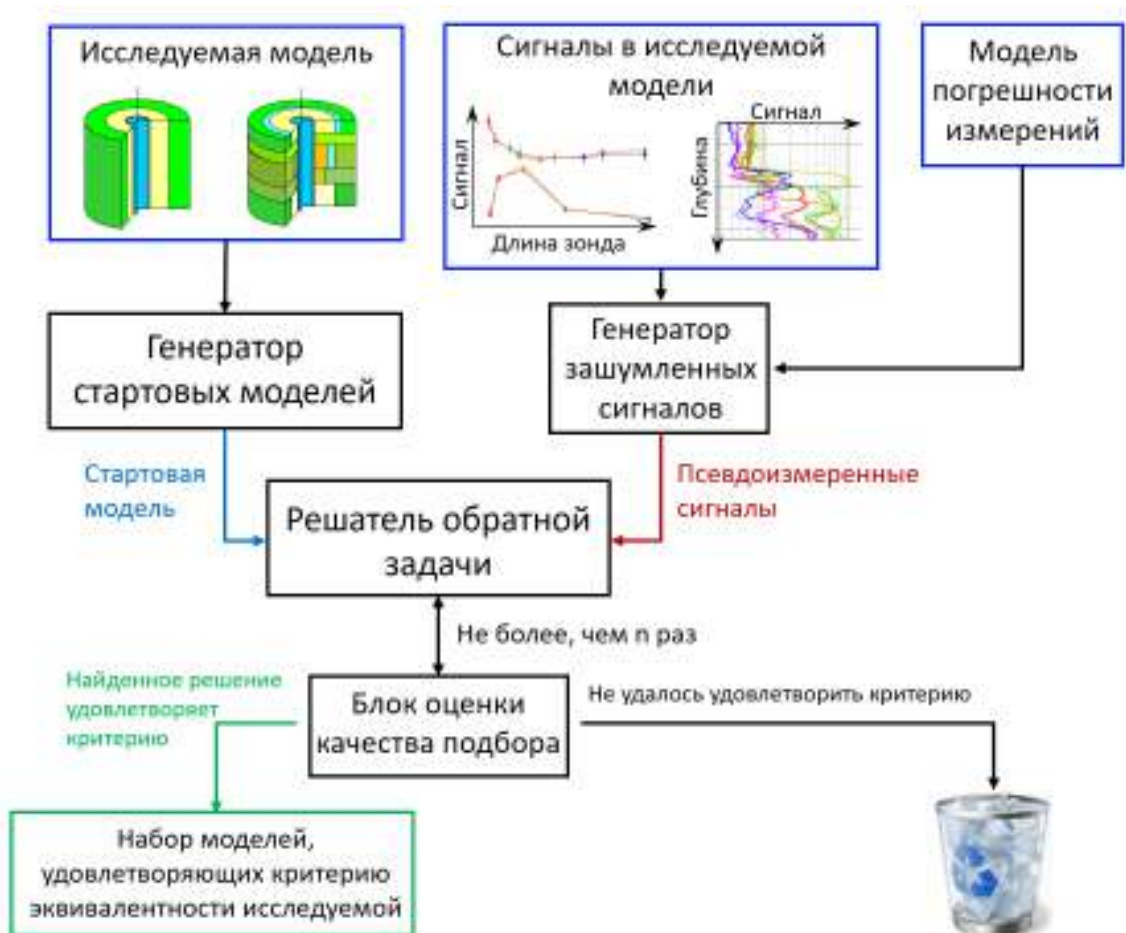
Рисунок 2.4.2 – Принципиальная схема алгоритма для оценки точности восстановления параметров среды при двумерной инверсии с помощью статистического моделирования
