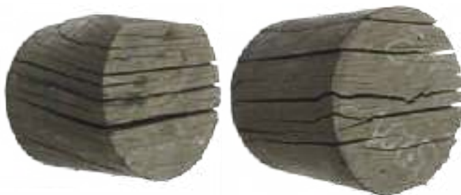
Рисунок 4.2.10 – Керн баженовской свиты после экстракции [Емкостные свойства..., 2012]
